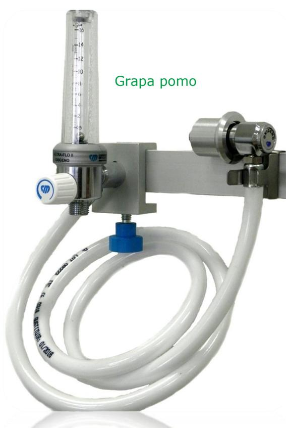
Tubo atóxico flexible con refuerzo de fibra de poliéster de 1,5 metros de longitud, sección ext./int. Ø12mm/ Ø6mm y presión de trabajo de 12 Kg/cm<sup>2</sup>.
