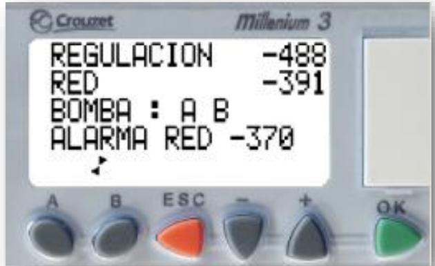
Sistema de control **Millenium 3** que permite el funcionamiento automático de las bombas con el objetivo de proporcionar el nivel de vacío adecuado y obteniendo un rendimiento óptimo gracias al funcionamiento de las mismas de forma secuencial.
