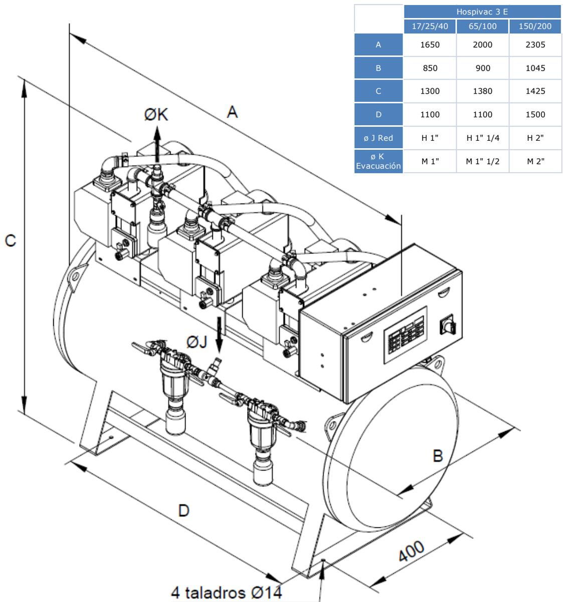
Depósitos horizontales de vacío que incluyen válvula de purga manual, válvula de salida y vacuómetro
