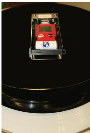
Registrador de temperatura que permite medir y controlar diferentes recipientes criogénicos destinados al transporte de material biológico sin necesidad de software y cables específicos de conexión, pudiendo ser conectado a cualquier PC mediante conexión USB, pudiendo generar automáticamente informes en PDF con información de estadísticas, alarmas, gráfico de temperaturas, etc.
