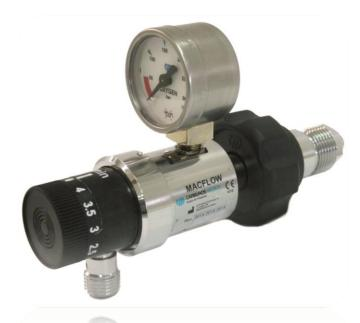
El regulador de caudal **Macflow** es una válvula reguladora de caudal para uso en botellas de alta presión de Oxígeno y de Aire Medicinal, obteniendo una presión fija y constante a la salida de 3,5 Kg/cm2.
