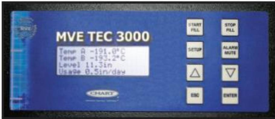
El controlador TEC 3000 emplea varias funciones avanzadas que permiten monitorizar y controlar con alta precisión las condiciones dentro de un contenedor.
